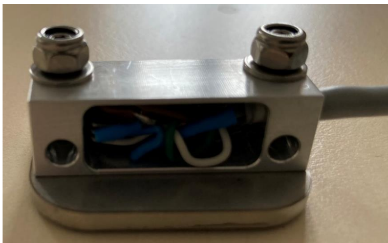
Obrázek 4: Snímač pro stojinu před aplikací zalévací hmotou
