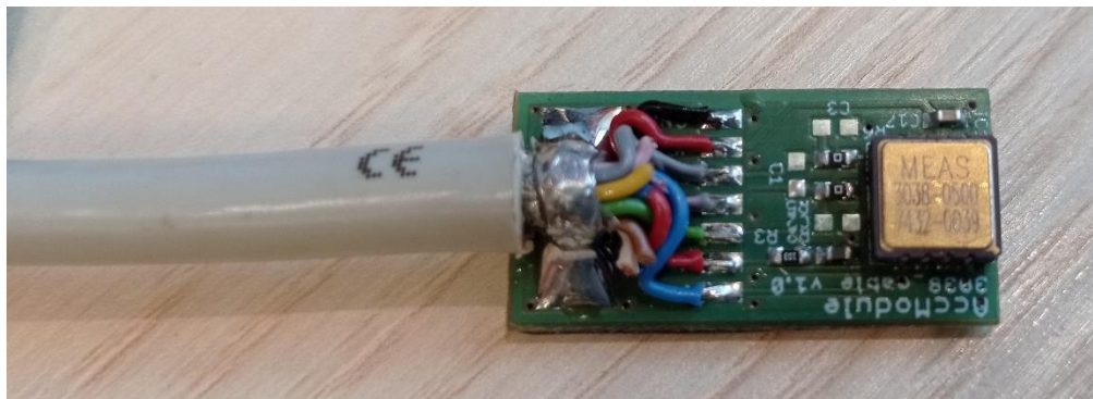
Obrázek 1: DPS 1osého snímače pro kolejnici před aplikací zalévací hmoty
