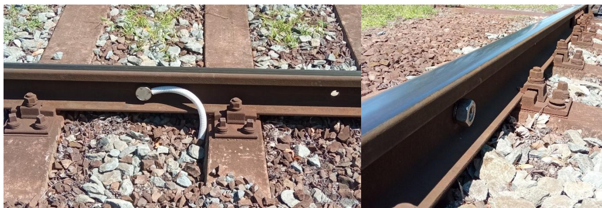
Obrázek 6: Umístění tenzometrického snímače v trati
